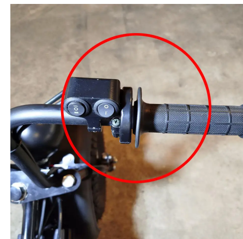
Рукоятка дроссельной заслонки. Переключатели света (для модели Dominator Pro).
